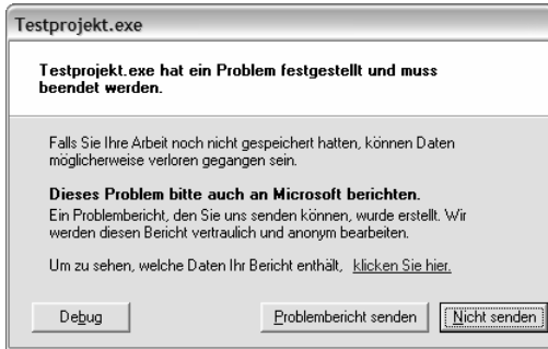
Abbildung 1.3 Klicken Sie in diesem Fall auf die Schaltfläche DEBUG, um den Debug-Vorgang zu starten.
