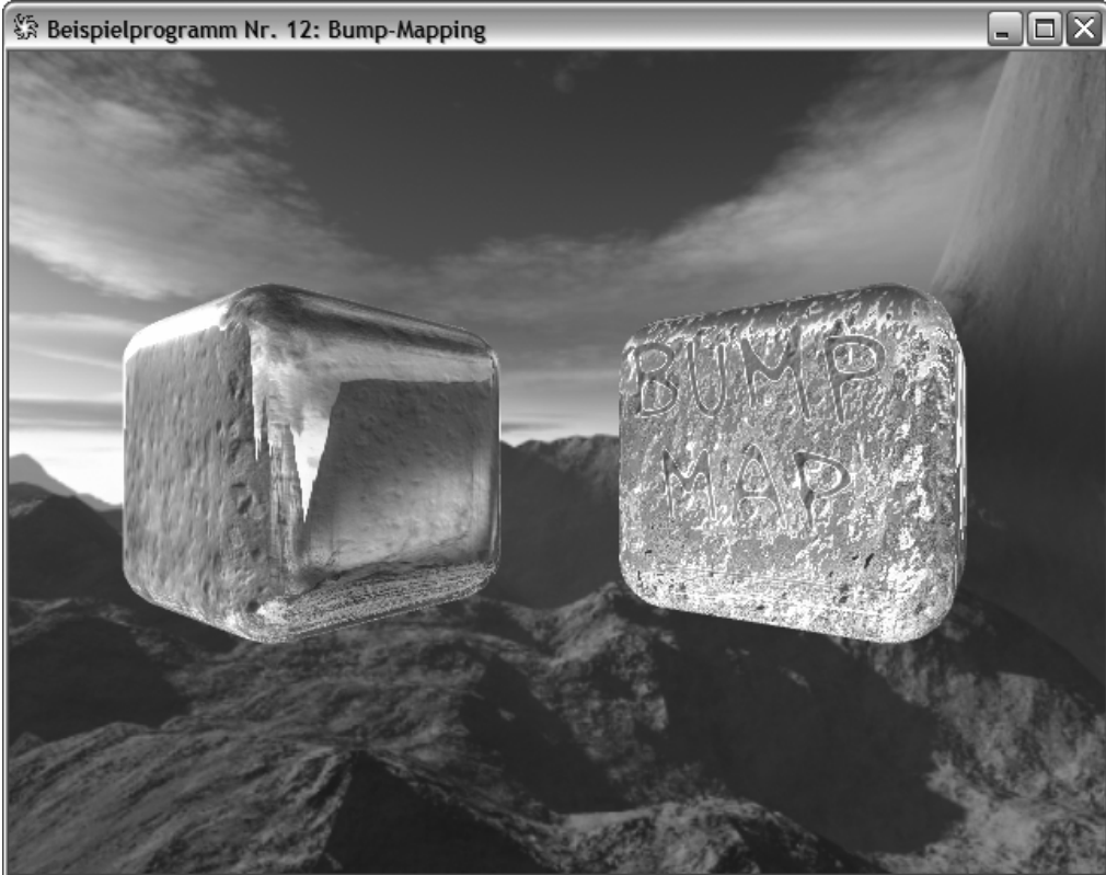
Abbildung 2.61 Eiswürfel mit und ohne Bump-Mapping
