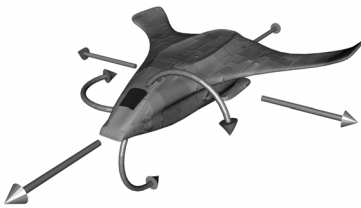
Abbildung 2.16 Die Welttransformation ist die erste Station in der Transformationspipeline. Verschiebungen, Rotationen und Skalierungen werden hier vorgenommen.
