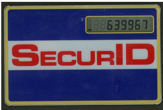
Abbildung 6.9: Ein TokenID von Security Dynamics Inc. zur hardwaremäßigen Generierung von Einmalpasswörtern
