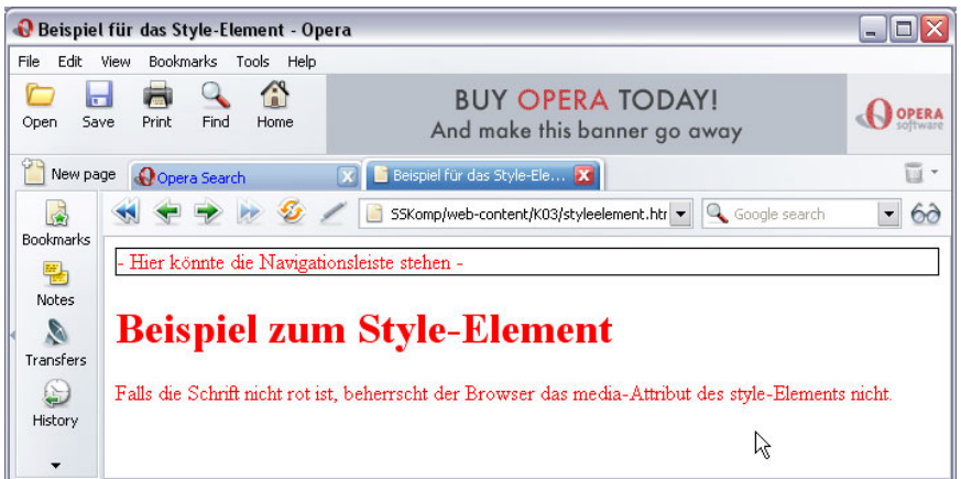
Abbildung 3.2: Bei der normalen Anzeige im Browser wird hingegen das Stylesheet mit der Angabe media="screen" verwendet.
