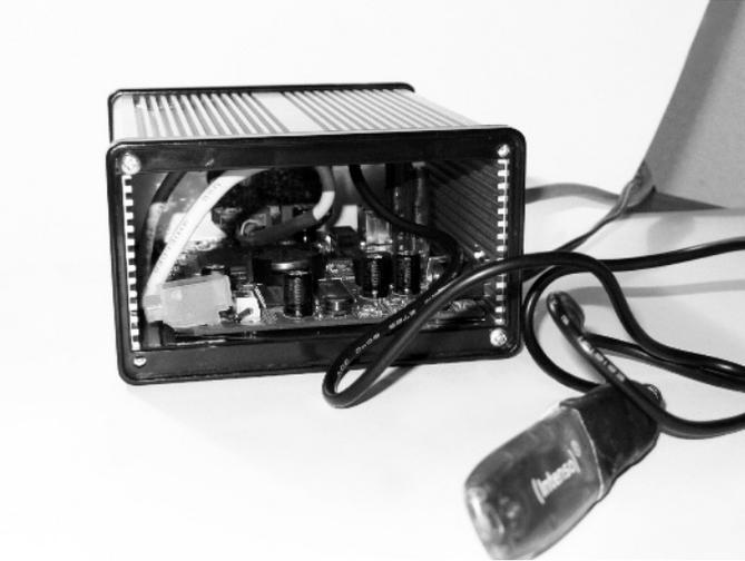
**Abb. 15.3.** Innenleben der Smart Camera auf Basis der NSLU2.
