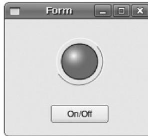
**Abb. D.5.** Verwendung des Qt Designer Plugins `qLed` im Beispiel `qt_use_plugin`.
