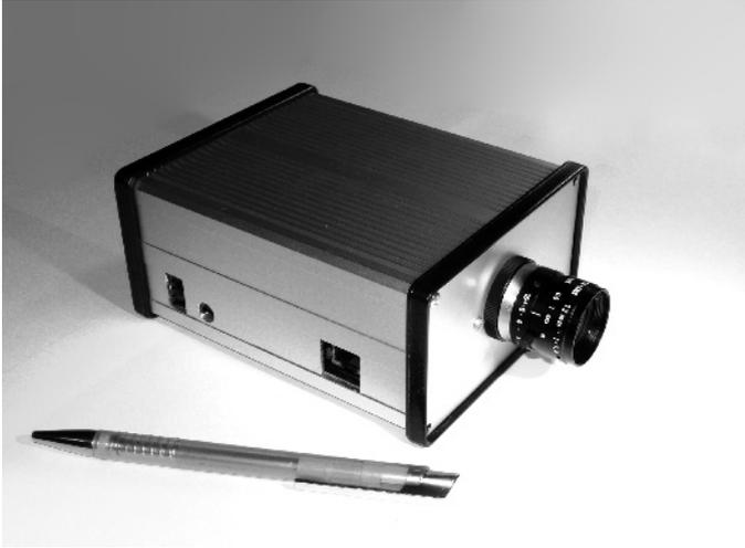
**Abb. 15.4.** Fertiggestellte Smart Camera auf Basis der NSLU2.
