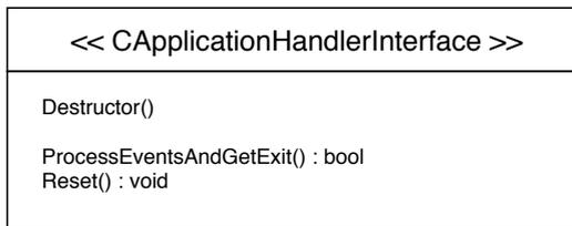
**Abb. C.3.** Darstellung der Methoden der Schnittstelle `CApplicationHandlerInterface` in UML.
