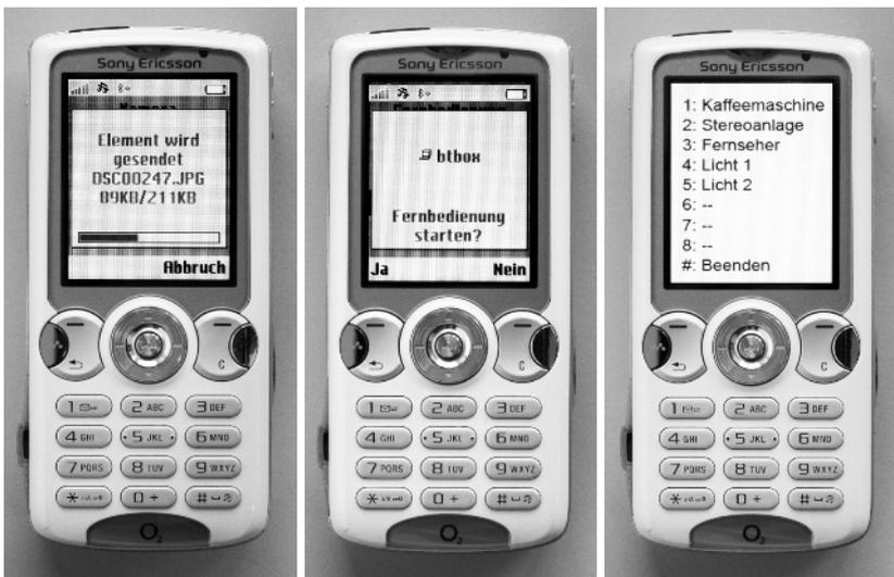
**Abb. 10.1.** Datenübertragung mit *obexftp* und Fernsteuerungsfunktion des Sony W810i.
