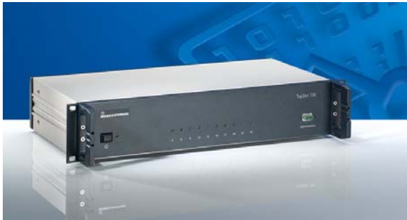
Abb. 32-1 ISDN-Verschlüsselungshardware der Firma Rohde & Schwarz SIT
