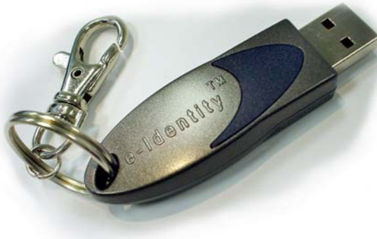
Abb. 23-3 Ein USB-Token funktioniert wie eine Smartcard, benötigt jedoch keinen Kartenleser.
