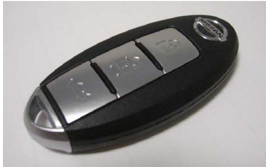
Abb. 23-4 Ein Autoschlüssel ist heute meist als Smart Token realisiert, das ein Challenge-Response-Verfahren ausführt.
