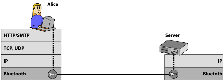
Abb. 33-4 Bluetooth ist eine Technologie für die drahtlose Datenübertragung über kurze Strecken. Kryptografie ist fest eingebaut.
