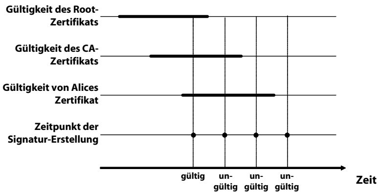
Abb. 29-2 Im modifizierten Schalenmodell ist eine Signatur dann gültig, wenn zum Signierzeitpunkt alle beteiligten Zertifikate gültig sind.
