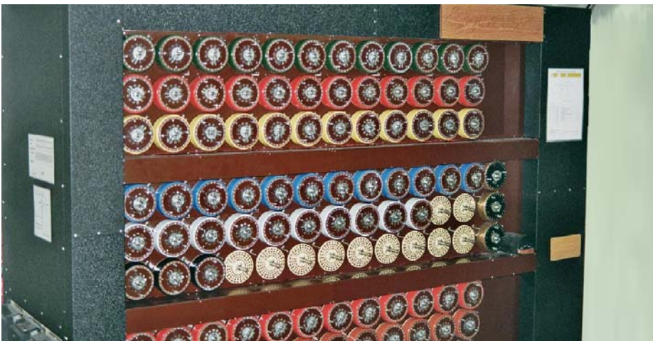
Abb. 5-4 Mit der Turing-Bombe knackten die Briten die Enigma.
