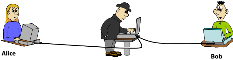
Abb. 20-4 Bei einer Man-in-the-Middle-Attacke greift Mallory aktiv in die Kommunikation zwischen Alice und Bob ein.
