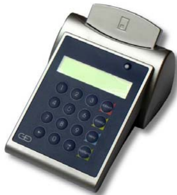
Abb. 23–2 Ein Karten-Terminal mit eingebauter Tastatur erschwert Malware-Angriffe.
