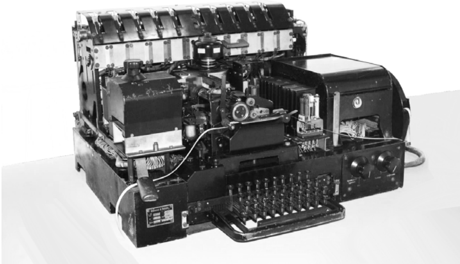
Abb. 5-11 Der Geheimschreiber war nach der Enigma das bedeutendste deutsche Verschlüsselungsgerät des Zweiten Weltkriegs.
