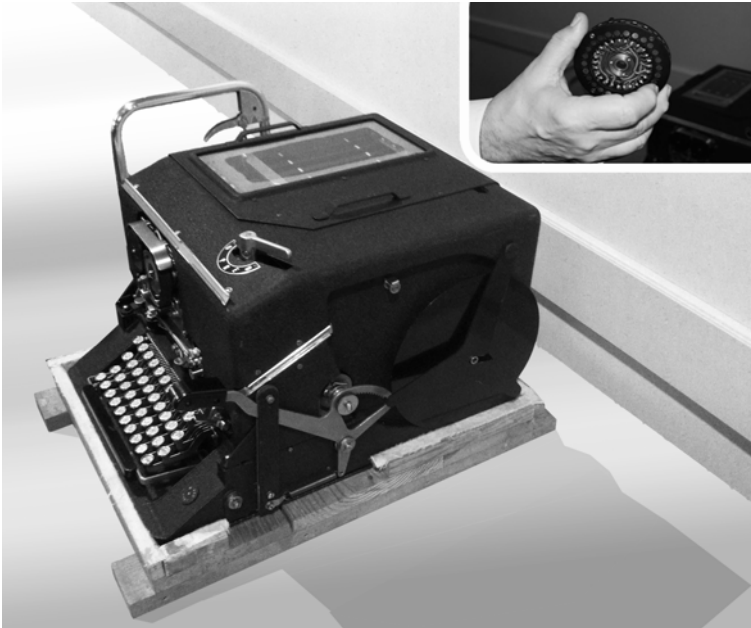
Abb. 5-5 Die SIGABA wurde von den US-Amerikanern im Zweiten Weltkrieg eingesetzt. Sie bot eine größere Sicherheit als die Enigma.
