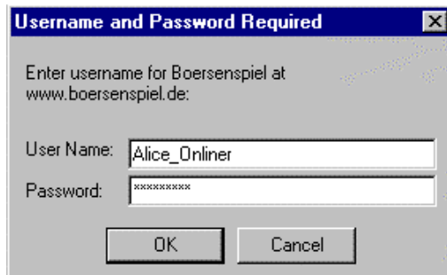
Abb. 37-1 Die Basic Authentication ist eine einfache Passwortabfrage, die von allen Browsern unterstützt wird. Leider wird dabei keine Kryptografie eingesetzt.
