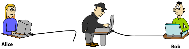
Abb. 20-5 Bei einer Hijacking-Attacke übernimmt Mallory eine Verbindung von Alice.
