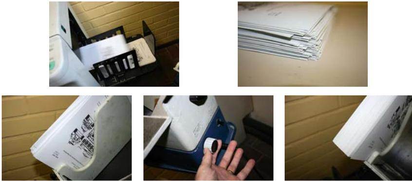
**Abb. 43.5.** Ein Bogenrüttler erzeugt durch Vibration einen passgenauen Papierstapel
