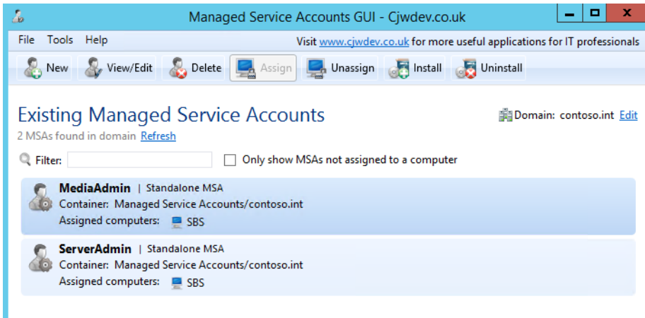
Abbildg. 12.1 Verwaltete Dienstkonten können Sie schnell und einfach mit der Freeware Managed Service Accounts GUI anlegen
