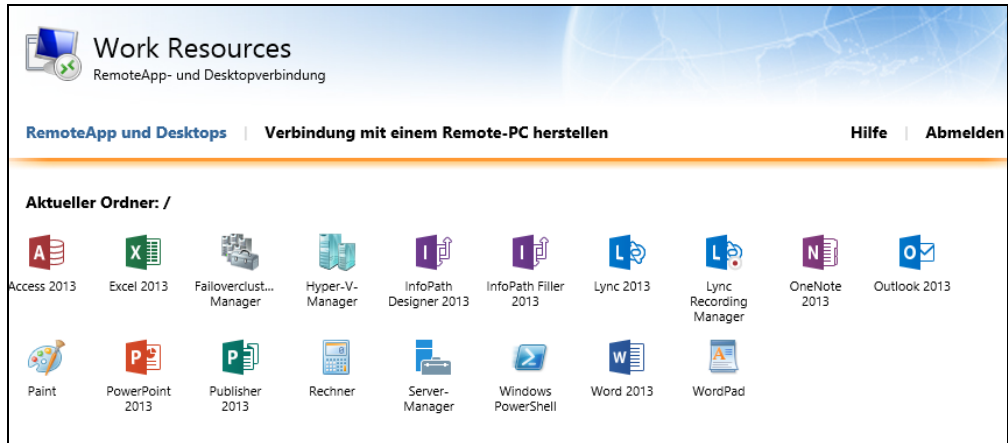
Abbildg. 28.9 Web Access für Remotedesktopdienste steht nach der Installation bereits über SSL zur Verfügung
