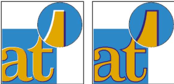
Passungenauigkeit ohne Überfüllung (links) und mit Überfüllung (rechts)
