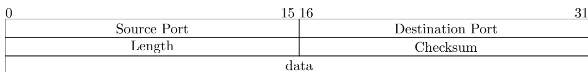
Abbildung 4.3.: User Datagram Protocol Header
