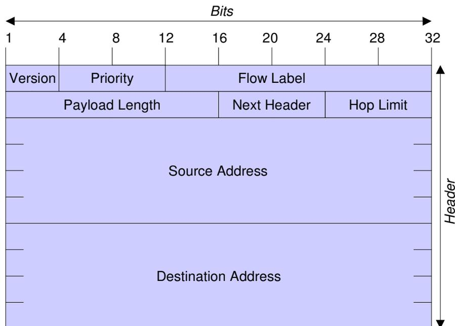
Abbildung 25 IPv6-Basis-Header.
